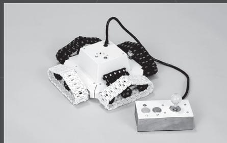
確実な「安定」と360度「自由」に動かせる車輪があったら未来に安心・安全を届けられるのではないかと…その思いから、タイヤでもクローラーでもない全く新しい車輪を作ろうと思いました。クローラーの部品一つひとつに進行方向に対し、直角になるような小さいタイヤを埋め込んでいるため、クローラーを平行にスライド出来るようになってきました。このクローラーを4個組み合わせ、それぞれのクローラーを独立制御することで、どの方向にも移動させることが出来ます。ほとんどの部品は、CADで設計し、3Dプリンターで作成しました。
