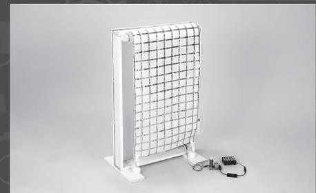
本作品は、「換気時に、室内に侵入する花粉の全体量を減らすことのできる不織布製ロールスクリーン」です。不織布には、銅箔テープが格子状に貼られており、「デスラコイル」で静電気の電圧を上げ、不織布に電圧の高い静電気を帯電させることで花粉を不織布に吸着させることが出来ます。汚れてしまった不織布は、切り取り線で切り離すことができます。網戸に直接不織布を貼ると室内に光が入らず暗くなってしまいますが、本作品は換気時のみスクリーンを下げて使用するので、換気時以外は外の光を室内に取り入れられます。
